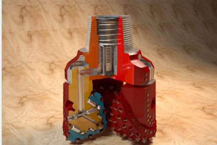
Рис. 3. Схема продувки подшипников
