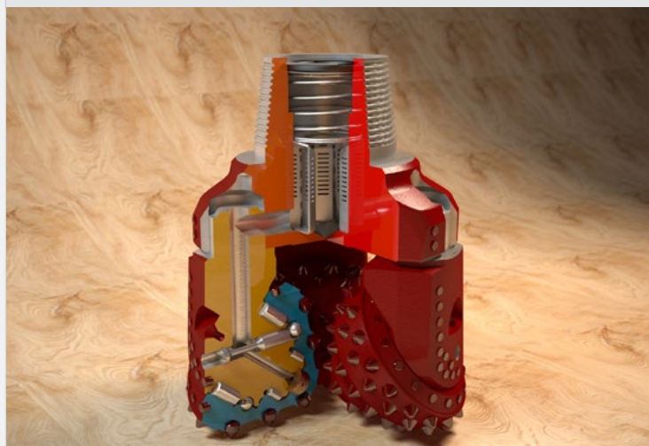
Рис. 3. Схема продувки подшипников
